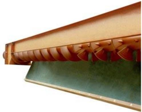
Кроме того, шнеки оснащены редукторным двигателем, соответствующим особенностям применения. Погрузочная зона шнека оборудована смешивающими лопастями.
