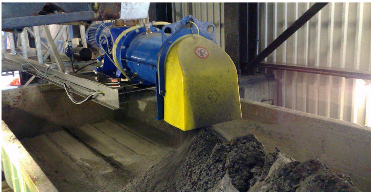
С точки зрения функциональности и экономичности, увлажнитель DUSTFIX является идеальным устройством для отвода, увлажнения и удаления пыли. Благодаря своим техническим возможностям, инновационной конструкции и невероятно короткому времени обработки пыли, DUSTFIX может обеспечивать загрузку открытых грузовиков или ленточных конвейеров без пыли.
