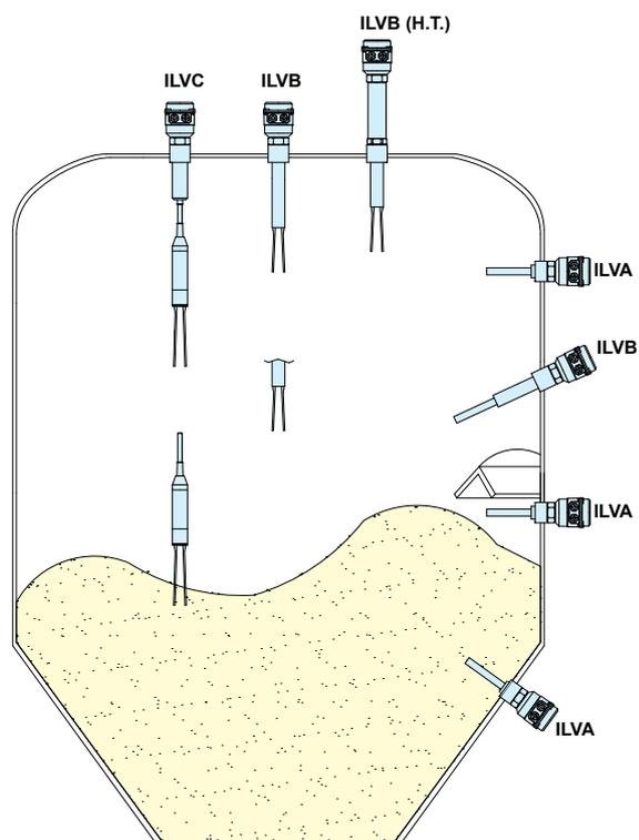
Вибрационные датчики уровня ILV устанавливаются на стенках бункера, силоса или воронки, в зависимости от задач, для которых они предназначены.
