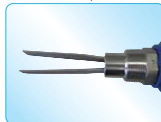
Метка показывает ориентацию вибрирующей вилки после монтажа. Метка должна быть расположена сверху, после установки датчика на боковую стенку силоса. В случае если ориентация метки установлена в сторону, то в следствии большой рабочей поверхности вилок, может возникнуть:
