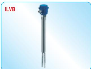
Модульное удлинение вала от 300 до 4000 мм с шагом 100 мм. С удлинительным стержнем датчики могут устанавливаться на крышу силоса
