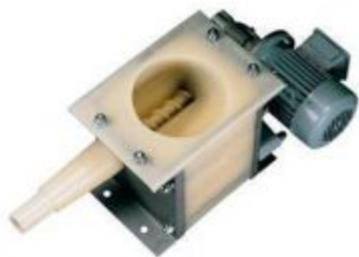
Шнековые микродозаторы MBW предназначены для объёмного дозирования свободно или среднетекучих порошковых или гранулированных продуктов, не склонных к уплотнению. Благодаря специальной геометрии корпуса из технического полимера обеспечивается равномерная подача и дозирование продукта. Для улучшения прохождения материала микродозатор может дополнительно комплектоваться небольшим пневмоактиватором. Микродозаторы MBW успешно
