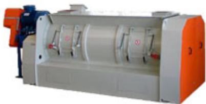
Одновальные смесители WBHP с бомболюком, открывающимся на 15°, и WBHT с люком, открывающимся на 60°, отвечают всем требованиям заказчиков, касающихся получения высокого качества смесей при периодическом смешивании. Выпускное отверстие на всю длину камеры смесителя обеспечивает максимально быструю и полную выгрузку продукта.
