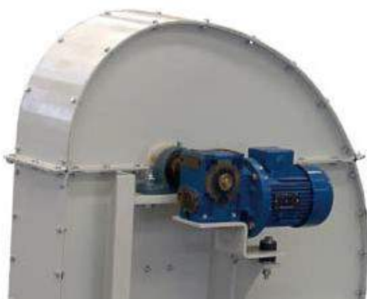
Верхняя секция с мотор-редуктором
