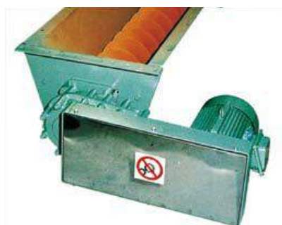
Привод с ременной передачей
