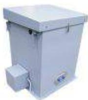
DUSTSHAKE R02 — это полигональный фильтр для обеспыливания силосов с пневматическим заполнением из автоцементовозов. Поток воздуха очищается от пыли с помощью специального фильтрующего элемента из полиэстера. После механического встряхивания фильтрующего элемента пыль оседает в силосе. Механизм встряхивания приводится в действие электродвигателем.
