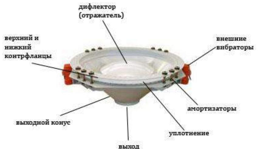
отверстие виброднища к транспортирующему устройству. Экстракторы с вибрирующими конусами ВА производства WAM® используются в многочисленных промышленных отраслях для облегчения разгрузки порошковых или зерновых материалов из силосов или больших бункеров, что обеспечивает оптимальный процесс извлечения материала "Mass Flow" и уменьшает образование заторов и «мышинных нор».
