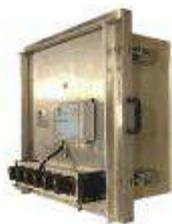
WAMAIR Vacuum представляет собой полигональный фильтр для отрицательного давления. Фильтрующие элементы устанавливаются горизонтально или вертикально, а система пневматической очистки встроена в крышку фильтра. Полигональные встраиваемые фильтры WAMAIR Vacuum были разработаны для применения в системах пневмотранспорта при отрицательном давлении (до -0,6 бар).
