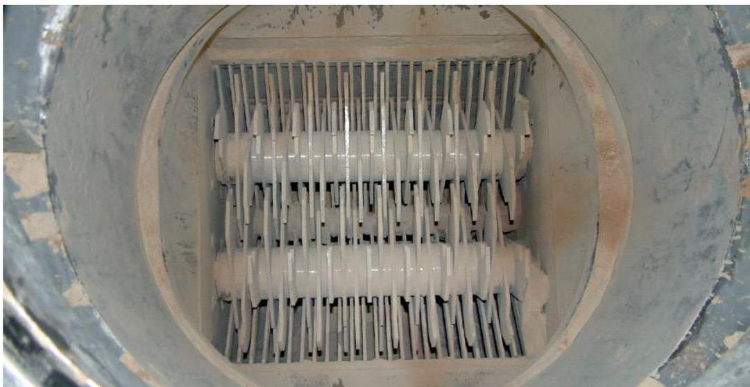
Измельчитель комков DLP является эффективным и экономичным устройством, которое специально разработано для измельчения рыхлых комков в сыпучих материалах, разгружаемых из силосов или бункеров.
