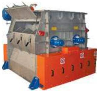
Двухвальные лопастные смесители периодического действия WTS — это смесители с двумя параллельными барабанами и двумя валами, которые вращаются в противоположных направлениях и оборудованы лопастями, обеспечивающими однородность смеси независимо от размера частиц и насыпной плотности смешиваемых продуктов. Высокое качество смеси достигается благодаря эффективности разнонаправленного вращения лопастей, перекрывающих друг друга.
