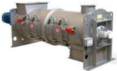
Конструкция одновальных горизонтальных непрерывных смесителей WAN представляет собой смесительную камеру с загрузочным патрубком с одного конца и разгрузочным патрубком с противоположного конца, вентиляционное отверстие, смесительный ротор, две пластины, закрывающие торцы камеры с размещенными в них концевыми подшипниками в комплекте с продувными уплотнениями вала, и привод. Смесительные элементы в форме плуга или лопаток
