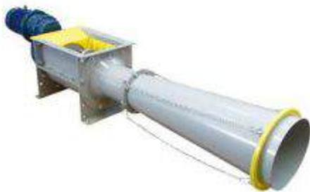
Шнековый уплотнитель пустых мешков СОМ принимают фрагменты мешков или целые пустые мешки из устройства, опорожняющего эти мешки, после чего СОМ прессует мешки, уменьшая занимаемый ими изначально объем примерно в восемь раз. Собирая разорванные мешки в полиэтиленовый большой мешок, периодически разрезая и вновь смыкая его, можно с легкостью отводить их для переработки.
