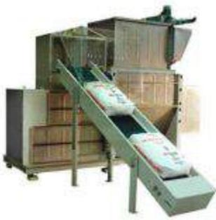
Автоматический растариватель мешков RSA применяется для открывания и опорожнения одно- или многослойных бумажных мешков, мешков из полиэтилена, бумажных мешков с внутренним слоем из полиэтилена, из свойлоченного пластика и из свойлоченного пластика с внутренним слоем из полиэтилена.
