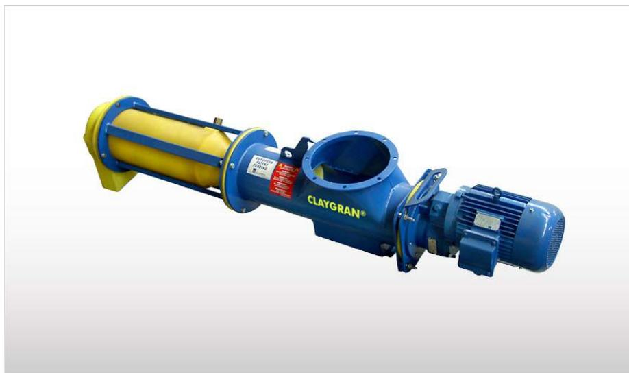
Конструкция увлажнителя пыли CLAYGRAN включает в себя трубчатый корпус из углеродистой стали с внутренним покрытием из технического полимера SINT, комбинированный винт, выполняющий функции перемещения и смешивания, выполненный полностью из технического полимера SINT, вертикальный патрубок загрузки из углеродистой стали, патрубков выгрузки из полимера SINT, форсунку для подачи жидкости, расположенную в зоне
