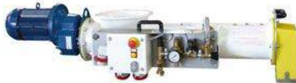
Станок идеален для производства отделочных работ с использованием особых материалов, а также для мелких ремонтных работ в исторических центрах, где пространство для работ ограничено. Технический полимер SINT®, которым покрыт смеситель, позволяет выполнять ежедневную чистку в конце дня в течение 2 минут.
